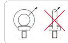
2. Hebezeug an den Augenschrauben befestigen. Das Gerät senkrecht heben.
