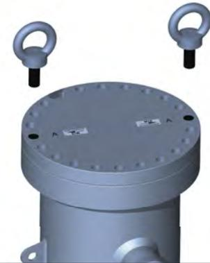
3. Die Augenschrauben gleichmäßig drehen, bis sich die Flanschplatte anhebt.
