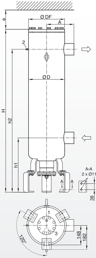
1 → Ölrückführung 10x1 Bördel (Gewinde: 5/8"-18 UNF)
