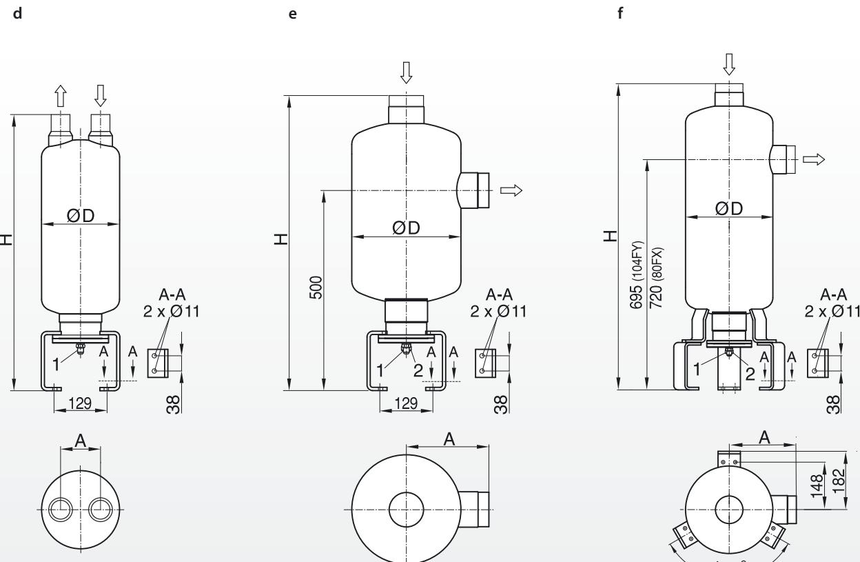
1) Ölrückführung 10x1 Bördel (Gewinde: 5/8"-18 UNF)
