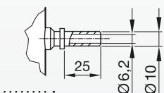
2) Anschluss für Minimal-Füllstandsüberwachung
