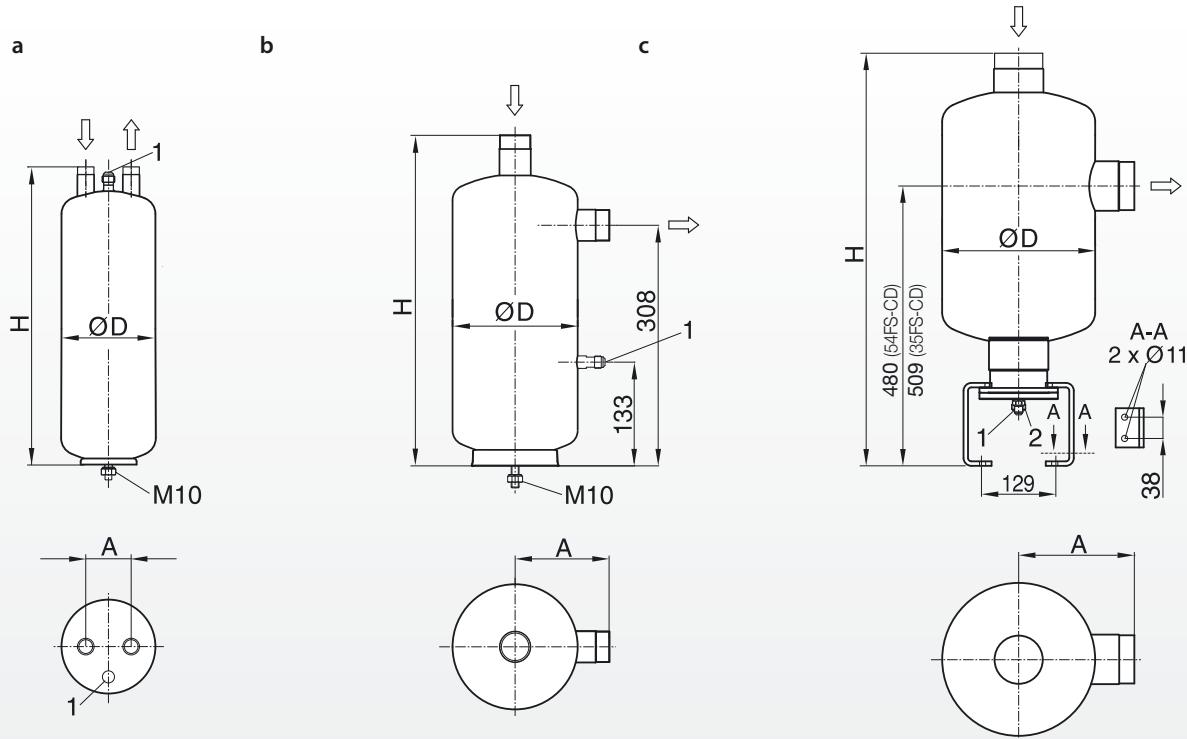
1) Ölrückführung 10x1 Bördel (Gewinde: 5/8"-18 UNF)
