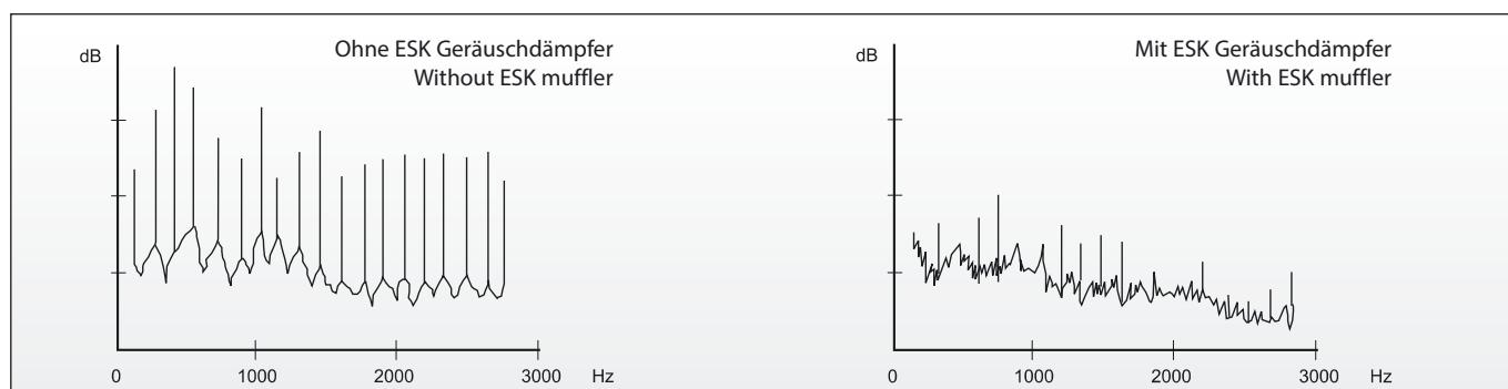
ESK-Geräuschkämpfer sind für den Betrieb mit HFKW- und HFCKW-Kältemitteln einsetzbar, die Komponenten der Baureihe GD sind außerdem für den Einsatz mit R410A und R744 (CO<sub>2</sub>) freigegeben.
