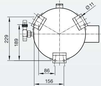
1) Ölrückführung, 10 mm Lötanschluss (RAV-1"-10)
