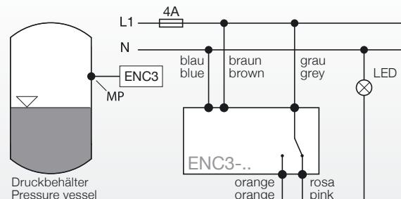
**Wiring diagram****Modellübersicht / Anwendung****Summary of types / application**
