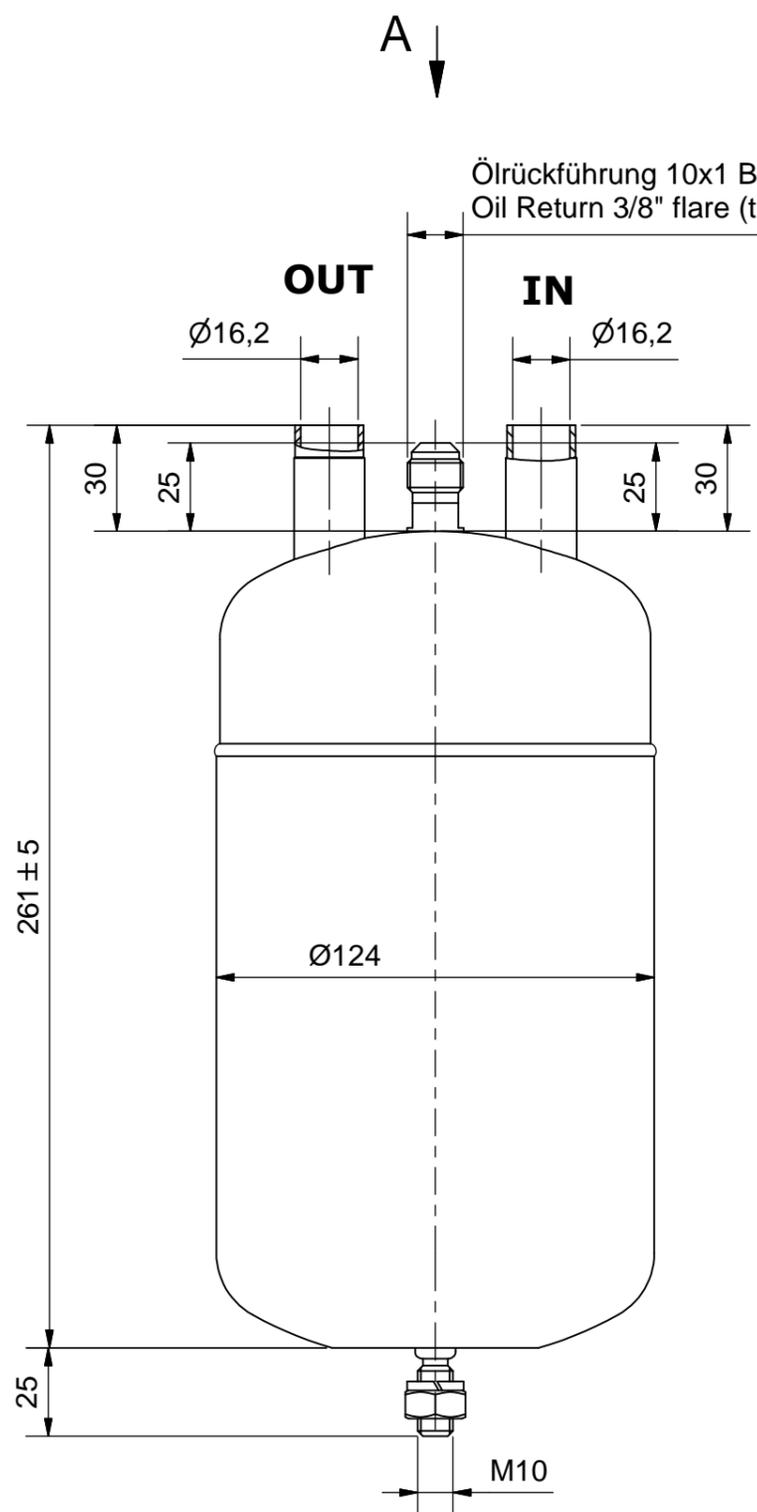
Ölrückführung 10x1 Bördel (Gewinde: 5/8"-18 UNF)
